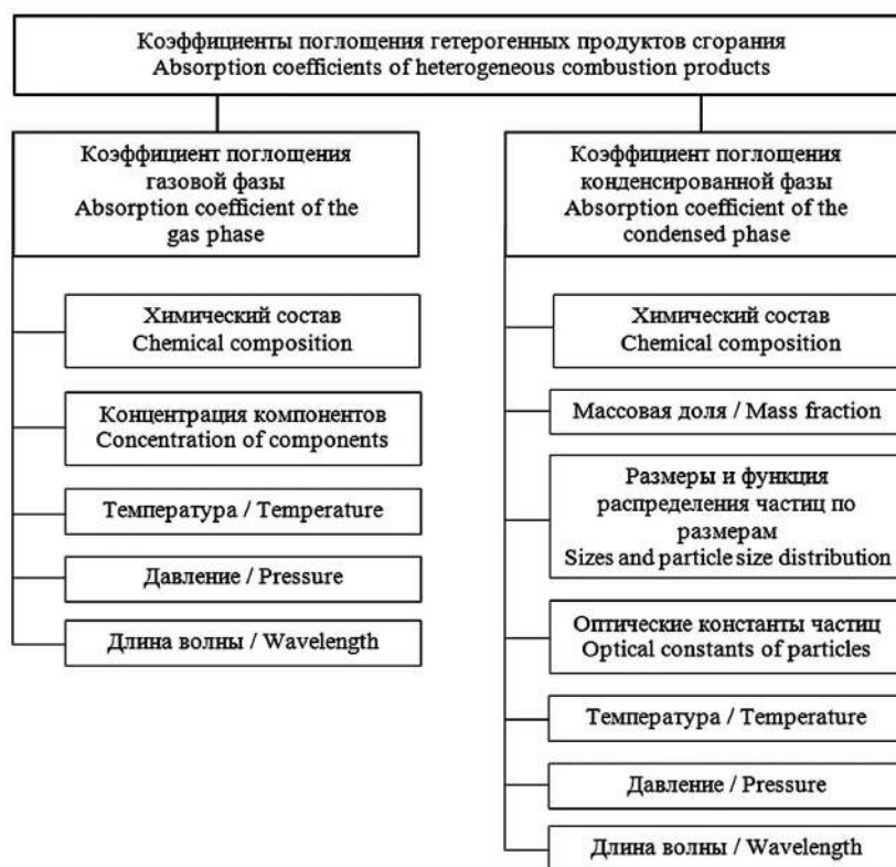
Рис. 2. Основные факторы, определяющие коэффициенты поглощения гетерогенных продуктов сгорания Fig. 2. The main factors determining absorption coefficient of heterogeneous combustion products
