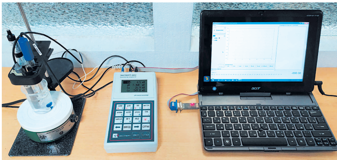
Рис. 1. Внешний вид установки по изучению сорбции тяжёлых металлов Fig. 1. The appearance of the installation for the study of sorption of heavy metals
