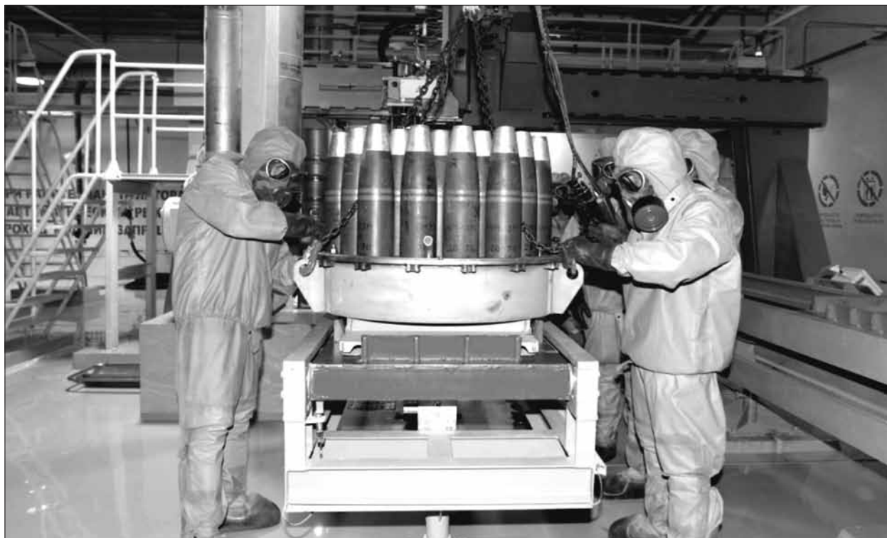
Рис. 1. Химические боеприпасы на автоматизированной поточной линии по их уничтожению
