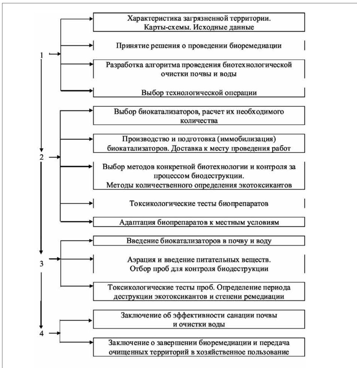
Рис. «Дорожная карта» – порядок действий при санации почвы и очистке воды in situ
