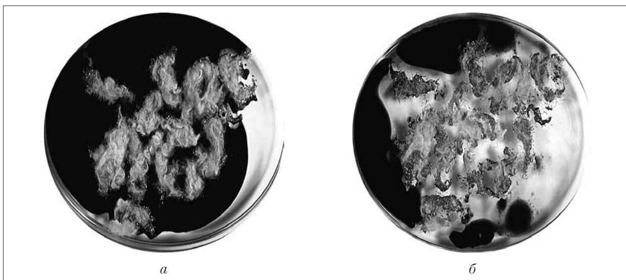
Рис. 4. Изменение площади поверхностного пятна нефти под действием сорбента ( V_o = 50 мл, m_w = 2 г): а , б ) время после размещения сорбента t = 10, 210 с.
