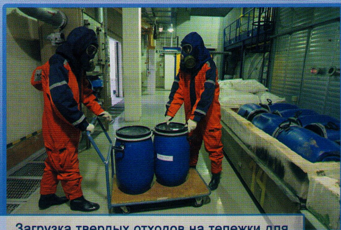
Загрузка твердых отходов на тележки для утилизации в печи
