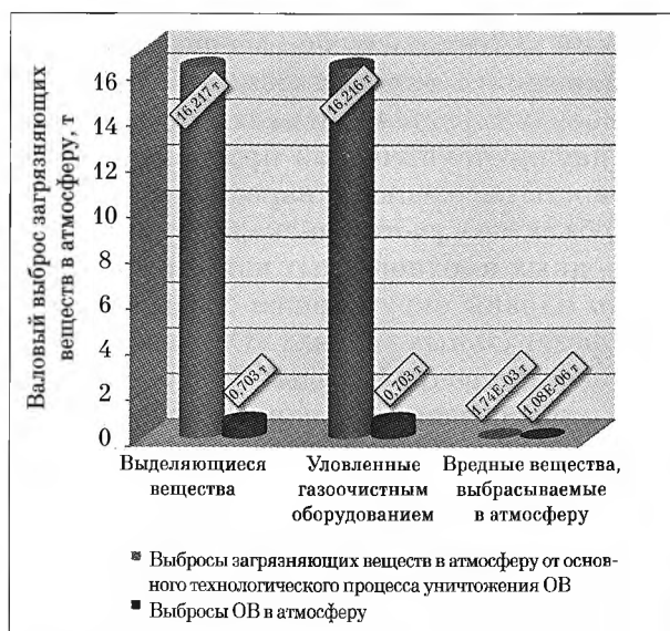
Рис. 1. Эффективность мер по снижению выбросов загрязняющих веществ в атмосферу на примере выбросов от основных производственных корпусов при уничтожении боеприпасов с заринном
