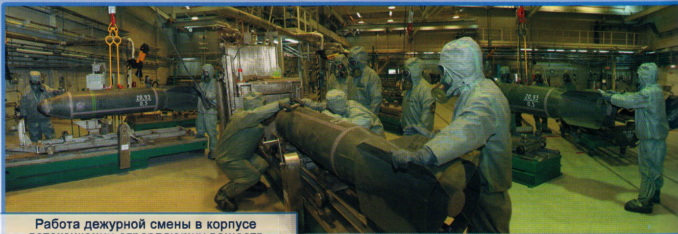
Рабочая смена на линии залива реагента в корпусе детоксикации
