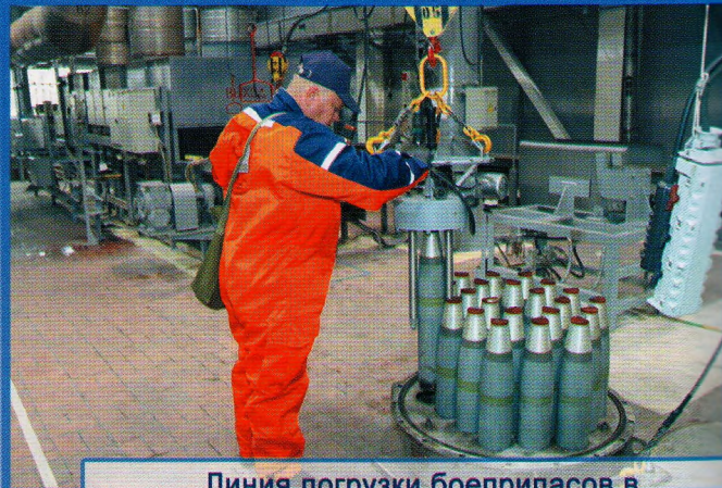
Линия погрузки боеприпасов в гермоконтейнеры
