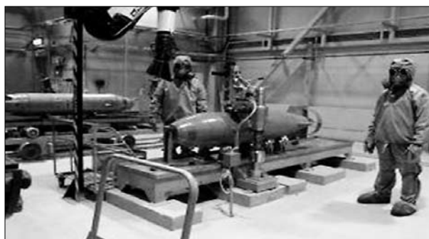
Пост расснаряжения авиационных химических боеприпасов
