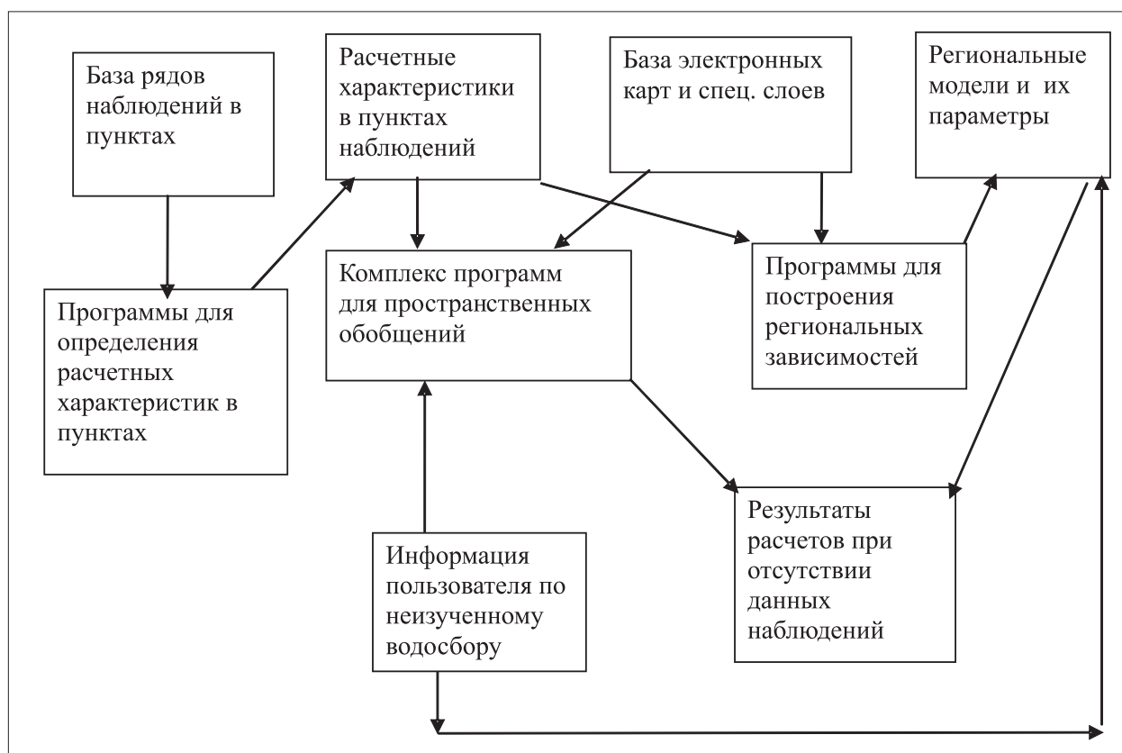
Рис.1. Общая схема региональной ГИС для выполнения гидрологических расчётов
