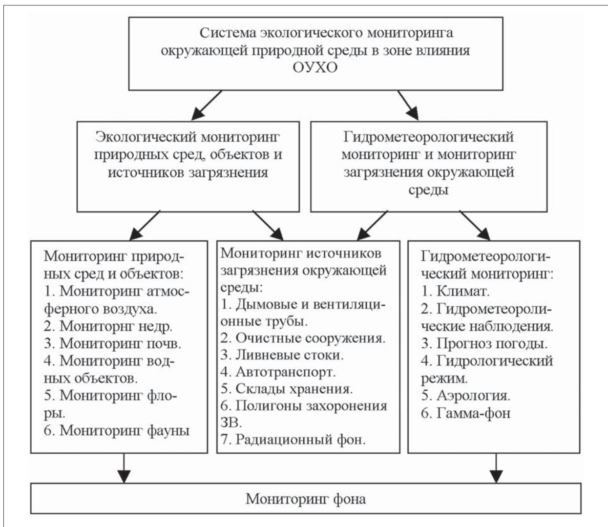
Рис. 3. Структура системы экологического мониторинга окружающей природной среды в районе размещения ОУХО
